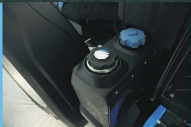
Depósitos de combustible y Adblue
